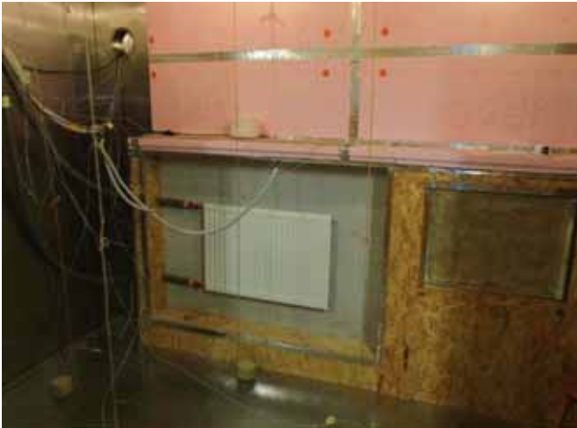
Obr. 3 Pohľad do komory 2, interiérovej na deliacu stenu s osadeným vykurovacím telesom
